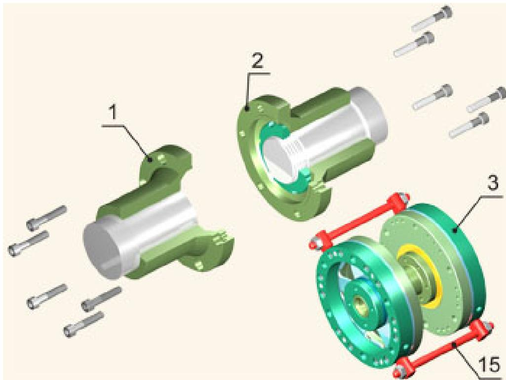
Монтаж проставки 3 в пространство между полумуфтами 1, 2 осуществляется при помощи приспособлений для осевого обжатия 15 (может поставляться в комплекте с муфтами) или, если имеется такая возможность, за счет сдвига вала привода в осевом направлении.
