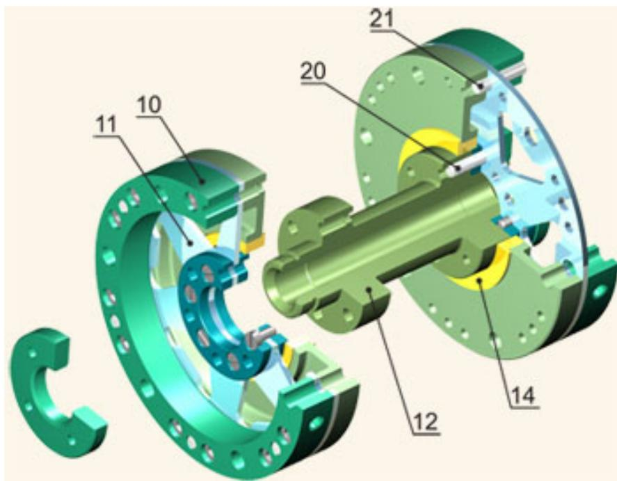
Проставка 3 включает втулку 12 и два пакета упругих элементов 10, включающих, в свою очередь, набор пластин 11, четыре фланца и комплект призонного крепежа каждый. Крутящий момент между деталями в пределах проставки передается цилиндрическими штифтами 20, 21.
