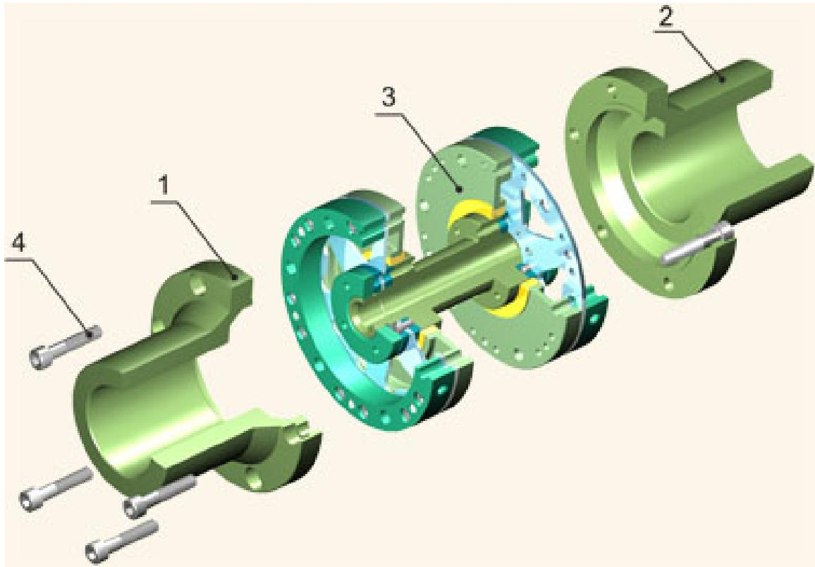
Муфта состоит из двух полумуфт 1, 2 и проставки 3, содержащей пакеты упругих элементов. Проставка 3 крепится к полумуфтам 1, 2 при помощи 4-8 стандартных винтов 4 с каждой стороны. Проставка 3 центрируется с полумуфтами 1, 2 по специальному центрирующим пояскам. Крутящий момент между полумуфтами 1, 2 и проставкой 3 передается трением между их фланцами за счет обжатия винтов 4.
